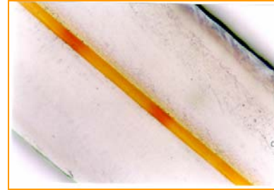
Medida de espesor total y parcial de cada una de las capas que componen un film. Visualización capa de EVOH.
